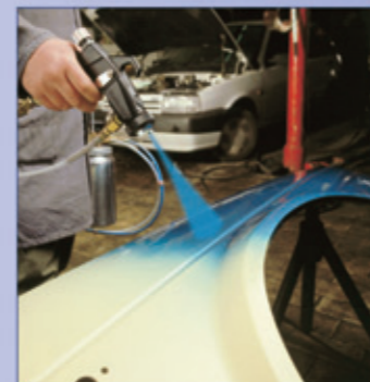
Karosserie- und Fahrzeugbau: Besonders handliches Arbeiten bei Voll- und Reparaturlackierungen mit der METACAP-Combi am Gurt.
